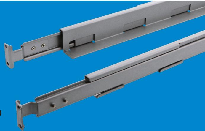
El kit incluye dos rieles de montaje con una profundidad ajustable de 478 a 1130mm. Su resistente estructura de acero es capaz de soportar unidades de protección eléctrica, equipos y dispositivos de red de hasta 444mm de ancho y con un peso de 80kg como máximo.
