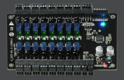
El EC10 es un avanzado sistema de seguridad para elevadores que permite controlar el acceso a los pisos de un edificio, concediendo la entrada sólo a los usuarios autorizados.
