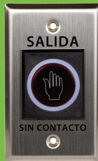
El botón K2 ofrece el novedoso concepto “sin contacto” al incorporar un sensor óptico infrarrojo que permite realizar la solicitud de apertura de una puerta sin la necesidad de hacer contacto físico con el botón, tan solo con el movimiento de la mano por encima del sensor a una distancia de hasta 10cm.
